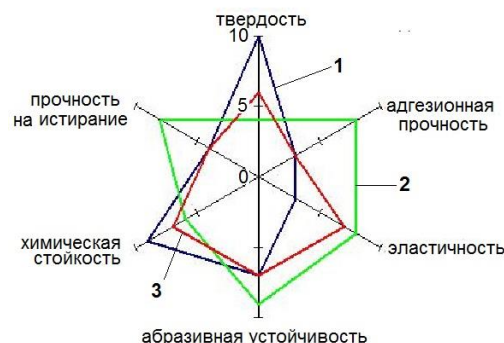
Рисунок 1. Характеристики покрытий, сформированных из композиций на основе различных акриловых пленкообразователей: 1 - эпоксиакрилат, 2 - уретанакрилат, 3 - полиэфиракрилат
